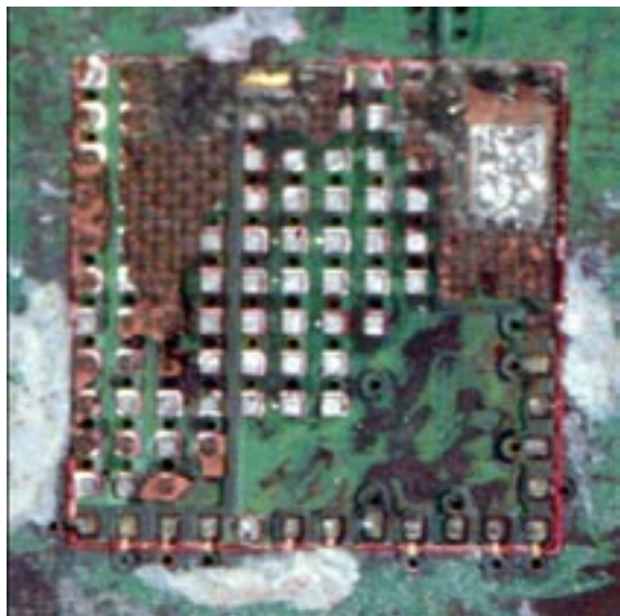
図6. 染色浸透試験:非常に強い半田接合
